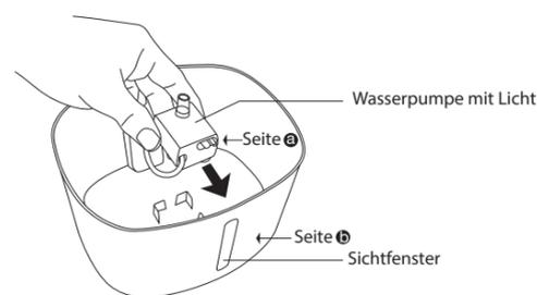
korrekte Installationsrichtung der Wasserpumpe:
