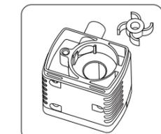
3. Entfernen Sie das Schaufelrad.
