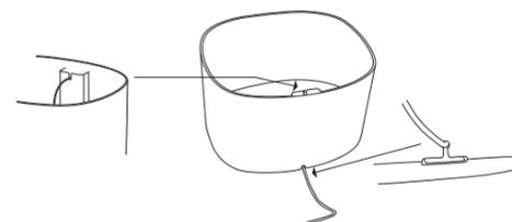
Bei der Installation der Wasserpumpe klemmen Sie bitte das Netzkabel fest.
