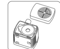
1. Öffnen Sie die Wasserpumpe entlang der Spalte.
