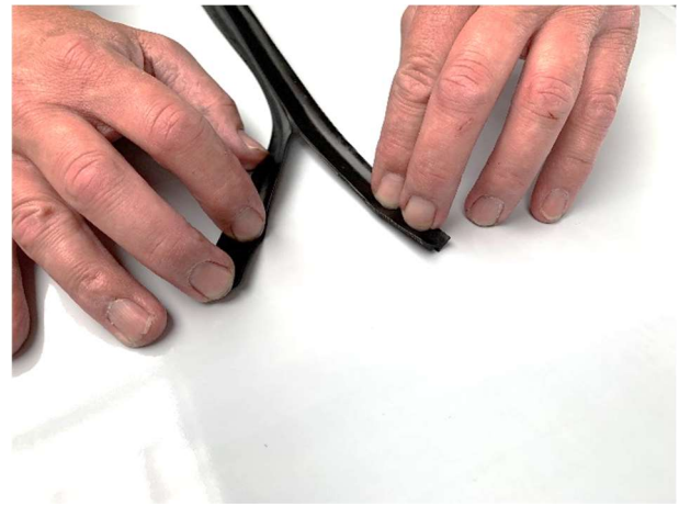
2. Die Keildichtung in der Mitte auseinanderziehen
