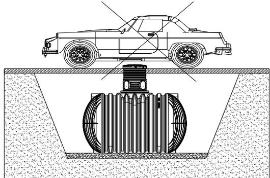
Die Tanks dürfen nicht im Grund-/ Schichtenwasser eingebaut werden. Ist zu erwarten, dass Grund-/Schichtenwasser auch nur gelegentlich auftritt, ist dieses durch eine Drainage abzuleiten.
